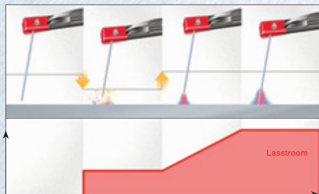
Stabiele lasboog door Soft-Start voor basische elektroden, die bij een lage lasstroom ontsteken.
