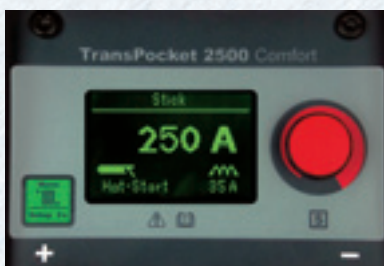
Eenvoudige menubesturing en duidelijke teksten. "Job" modus slaat individuele instellingen op. "Synergic" modus optimaliseert lasparameters voor vrij instelbare elektrodentypen en -diameters.
